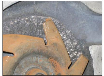
CAVITATION / CORROSION
