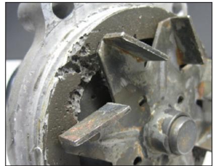
CAVITATION / CORROSION
