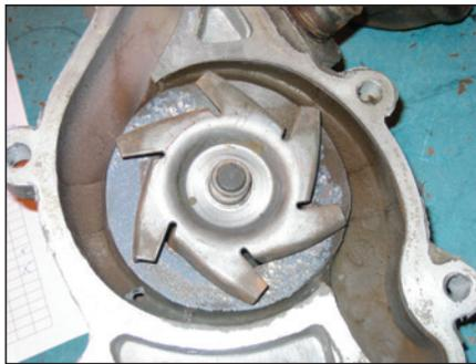
CAVITATION / CORROSION
