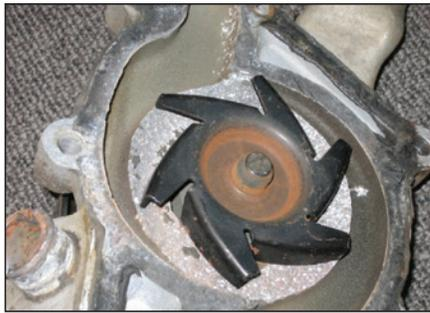
CAVITATION / CORROSION
